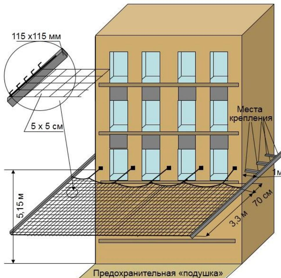
1. Каркас, на котором крепится страхующая сетка, рекомендуется изготавливать из металлической трубы квадратного сечения 115x115 мм и толщиной стенок 4-5 мм или круглой трубы диаметром 115 мм.
